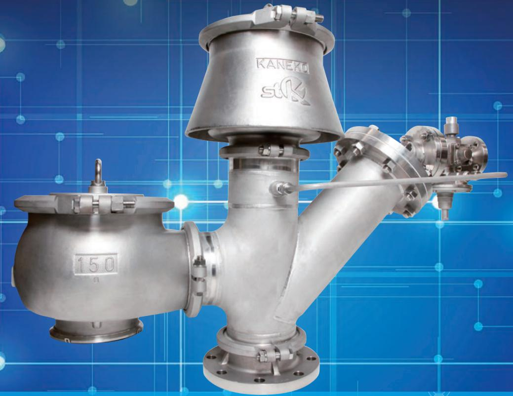
化学製品、医薬原料、純水、食品などを貯槽する際に安全面や品質管理上、空気や不純物の混入を防がなければなりません。キーパーブリザーは貯槽内圧低下の際、適切量の不活性ガスを瞬時に気層部へパージすることで、貯槽物と外気を遮断し、微加圧状態を維持することが可能です。また、内圧膨張の際は、圧力を確実に放出致します。
